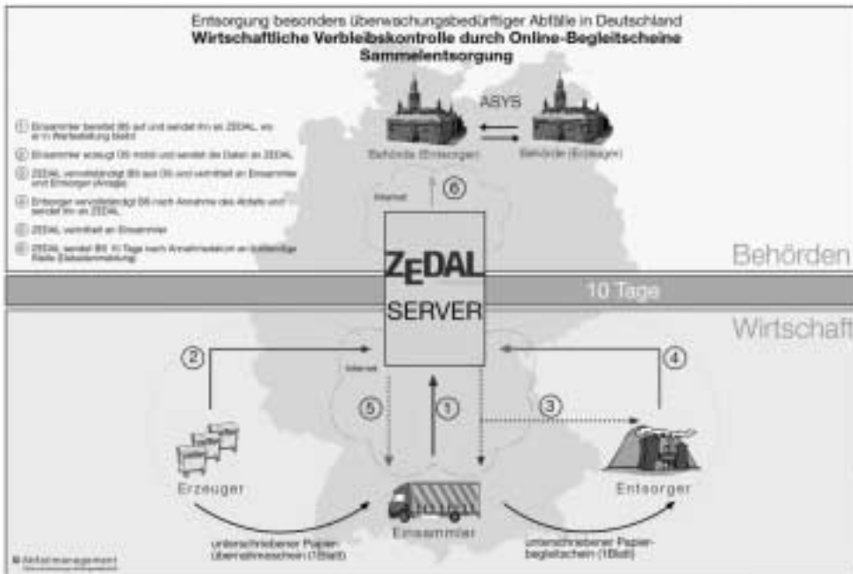
Bild 2: Schematische Darstellung des Vermittlungsprozesses durch den ZEDAL-Server bei Sammelentsorgung**
