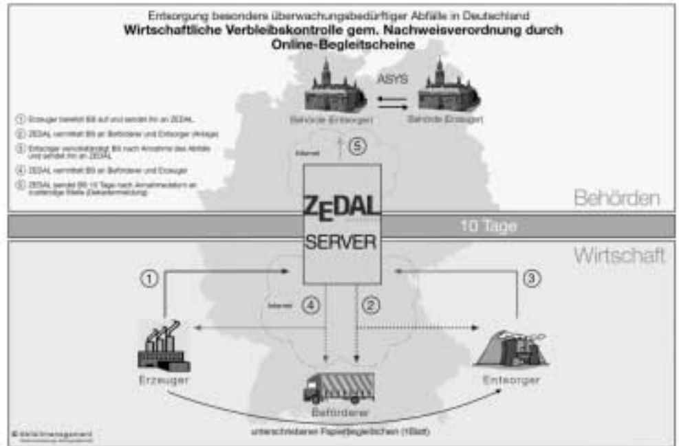
Bild 1: Schematische Darstellung des Vermittlungsprozesses durch den ZEDAL-Server*
